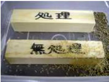
シロアリは、エコボロン PRO で適切に処理された木材を食べることが出来ません。エコボロン PRO の主成分であるホウ酸塩を摂取したシロアリはエネルギー代謝が出来なくなり、餓死します。また、この効果はシロアリに限らず、ヒラタキクイムシなどの食材甲虫にも同じ作用をもたらします。ホウ酸塩は京都大学、ハワイ大学、Forintek 研究所（カナダ）の共同研究チームにより、ハワイオアフ島と鹿児島吹上砂丘で 10 年来野外試験が続けられ、高い防蟻性が確認されています。
